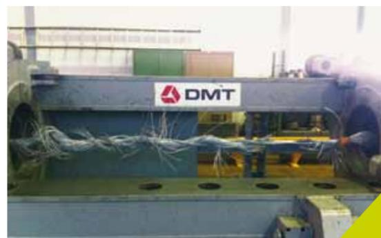
Essai de traction, jusqu'à rupture d'un câble éprouvette
